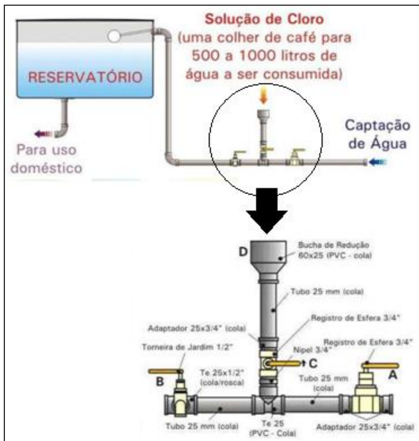
Figura 23 - Esquema do sistema de cloração desenvolvido pela Embrapa
